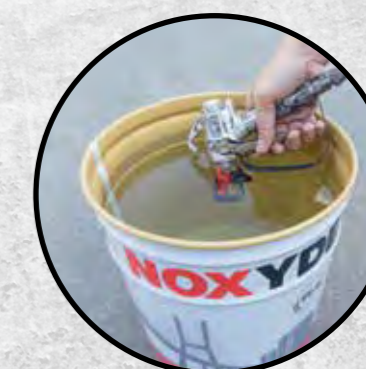
Jednoduché čištění Během přestávek jednoduše vložte stříkací pistoli do vody.
